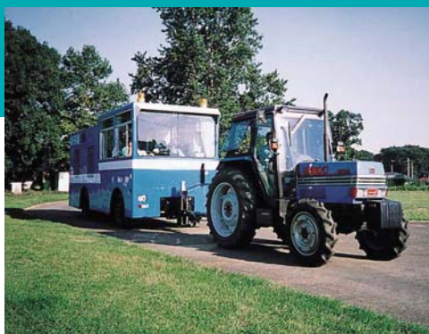
トラクターのけん引性能試験
