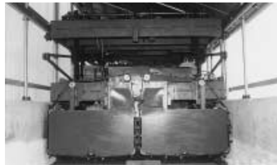
写真 32 サイレージ詰め込み・取り出し装置試作 2 号機 (サイレージ上部に上昇した状態)
