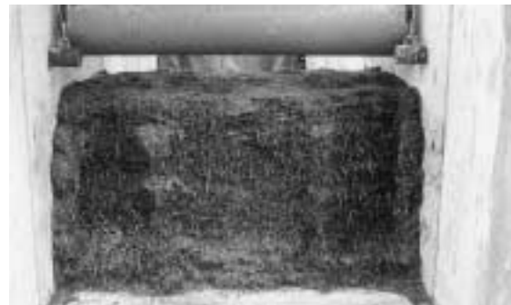
写真 31 サイレージ詰め込み・取り出し装置試作 1 号機によるグラスサイレージ取り出し面
