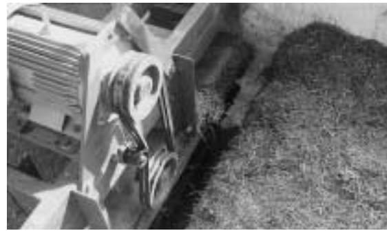
写真 30 サイレージ詰め込み・取り出し装置試作 1 号機によるグラスサイレージ取り出し作業
