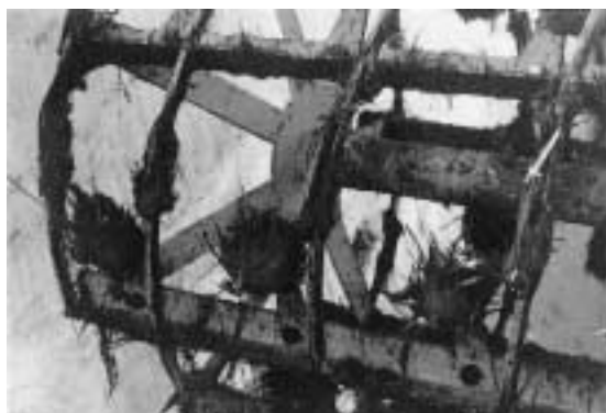
写真 14 掻き出し爪に付着したグラスサイレージ Photo 14 Grass silage caught by scratch knives
