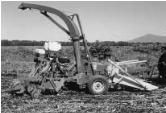
写真1 試作した収穫・施肥・播種同時作業機 Photo 1 Prototype seeder combined with rotary-tiller and forage harvester
