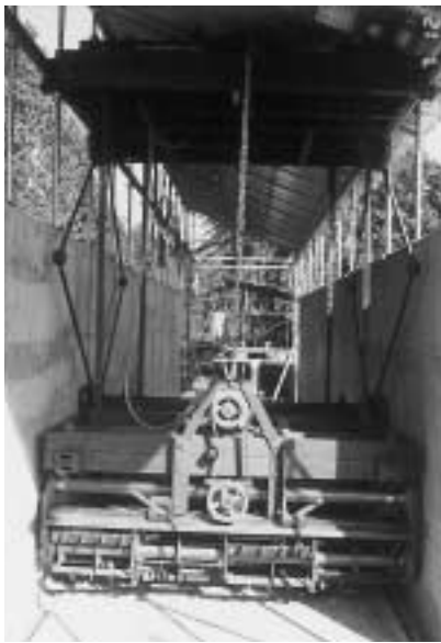
写真 16 サイレージ詰め込み・取り出し装置試作 1号機
