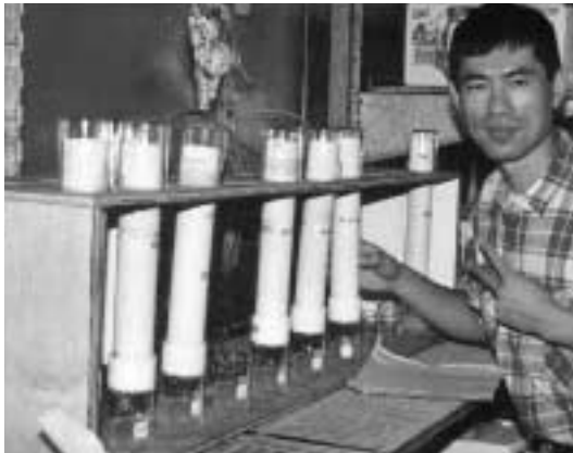
図4 無機態窒素測定に用いたカラムマイクロコズム 図は滲出法による測定を実施している場面。
