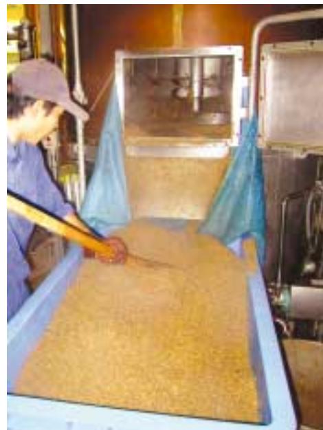
写真 コンテナサイロへの地ビール粕の詰め込み作業
