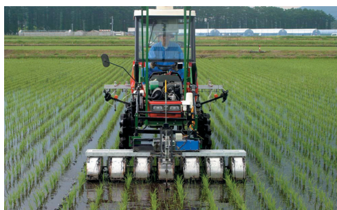
図1 ハイブリッド除草機による除草作業
