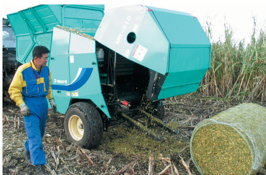
図1 実験に用いた細断型ロールベアラ(T社製MR810)
