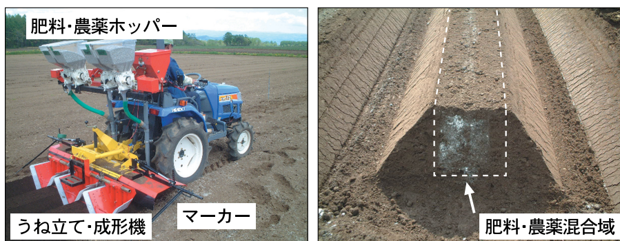
図2 うね立て同時部分施用機とうね内の肥料・農薬混合域
