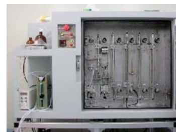
図3 米ぬかトコトリエノール分離装置 (3成分分離擬似移動層クロマト装置)
