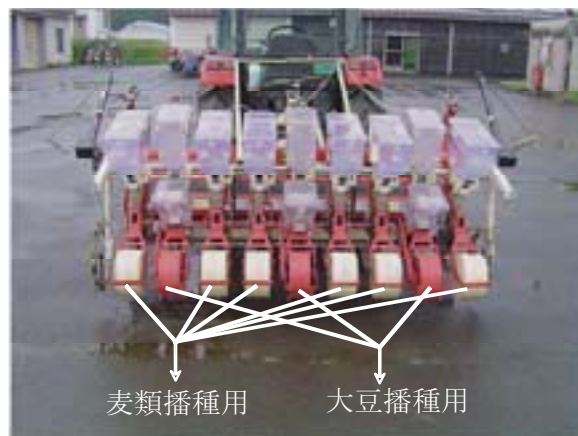
図2 麦類・大豆同時播種用のハローシーダー。 麦類用と大豆用の播種ユニットを交互に配列。
