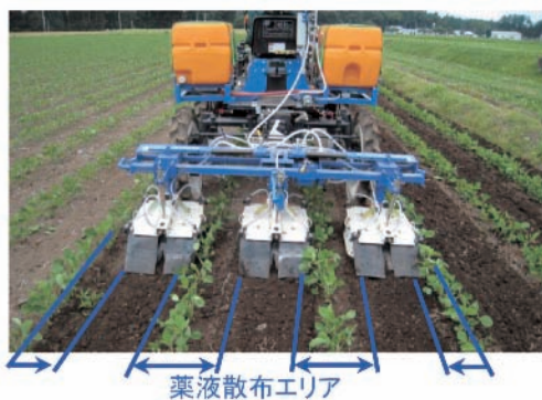
図1 試作した畑作用ハイブリッド除草機と主要諸元
