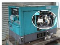
燃料加熱装置などの付加による簡易な改造済ディーゼル発電機は、未変換なたね油を燃料として1,250時間以上利用できます。これは、なたねの乾燥～搾油工程での電源利用を想定すると2ha分、7年間に相当します。
