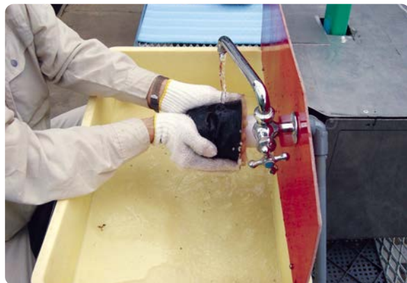
図3：ポットを強く握るとポットが回転せず、ブラシで内部を洗浄できる
