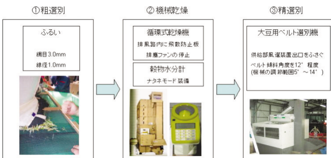
図1：市販農機の汎用利用によるナタネの乾燥調製・選別法
