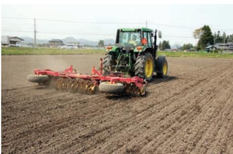
写真1：ハローパッカによる播種床造成（作業幅4.5m）
