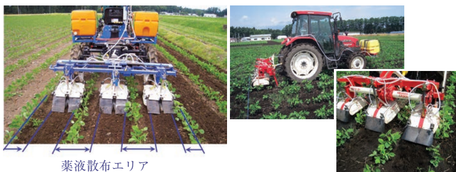
図1 / 開発した畑作用ハイブリッド除草機（左：乗用管理機型、右：トラクタ型）
