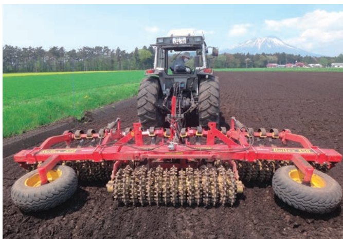
図1 / ハローパッカによる鎮圧作業
