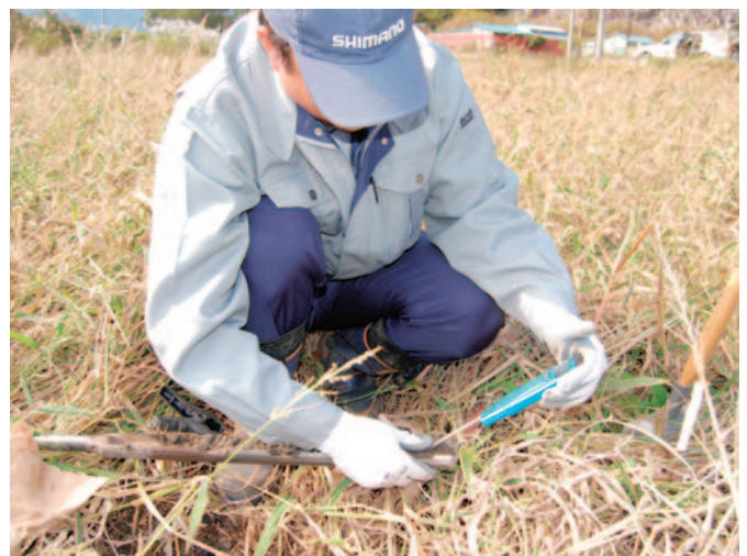
図3 / 採土器を用いた下層土の土壌ECの測定
