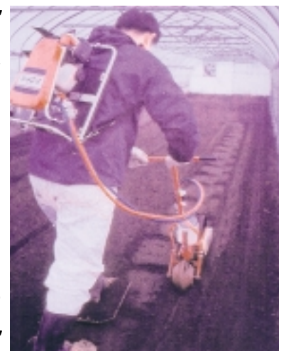
写真2：ソロバン玉型鎮圧輪を装着した播種機で、畑に連続した溝底畝を作り、播種。
