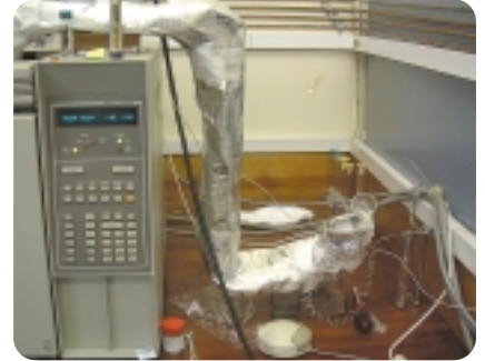
写真4: 臭い嗅ぎ装置
