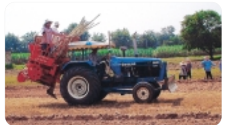
開発したサトウキビの部分深耕同時施肥・植付機
