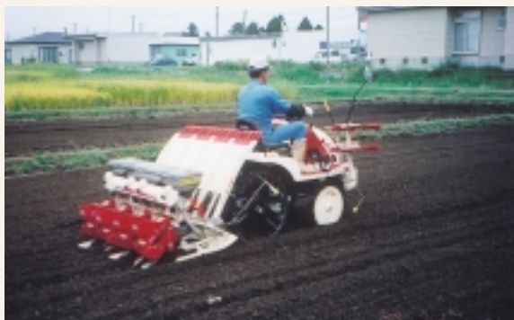
写真1：乗用4条田植機を改良した施肥同時播種機による小麦播種
