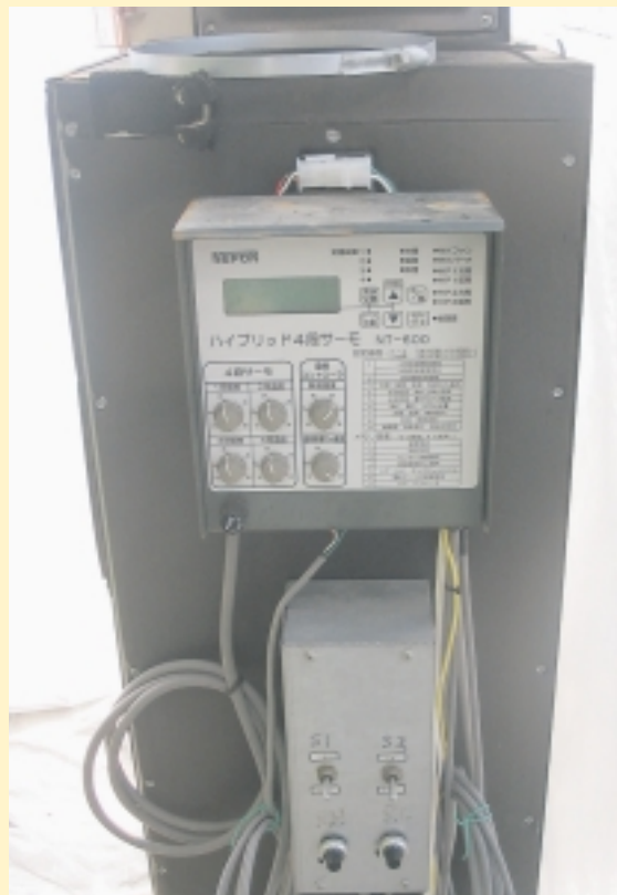
試験用ハイブリッドコントローラー
