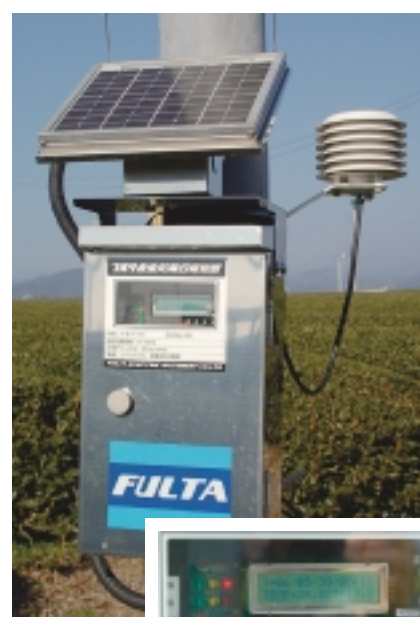
写真 開発した有効積算温度表示器 右下：表示部
