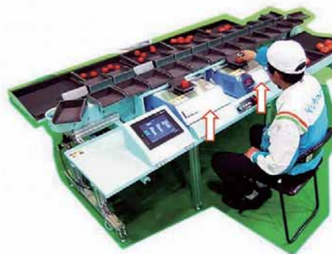
図1 小規模ラインに組込まれた拡散反射非接触測定方式の機器(手前中央に2台;赤い矢印参照) 写真提供:(株)クボタ
