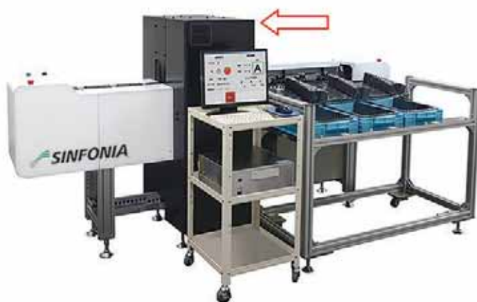
図2 1台で様々なサイズのトマトに適用可能な小規模ラインに組込まれた透過測定方式の非破壊測定機器(中央付近;赤い矢印参照) 写真提供:シンフォニアテクノロジー(株)
