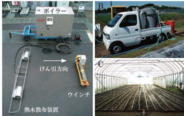
図2 熱水土壌消毒装置のシステム構成 A：けん引方式，B：パルスジェットボイラー， C：チューブ方式
