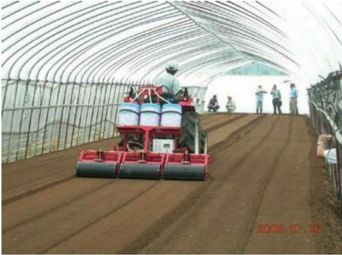
図8 キルパー専用機（試作機）による線状土壌注入処理
