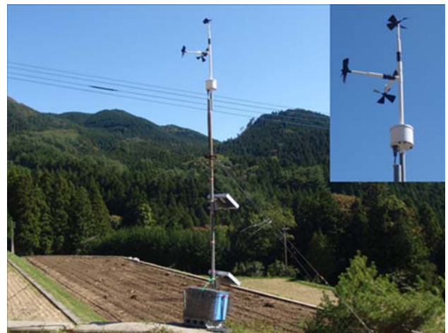
写真1 風速観測風景（左）とギルUVW風速計（右上）
