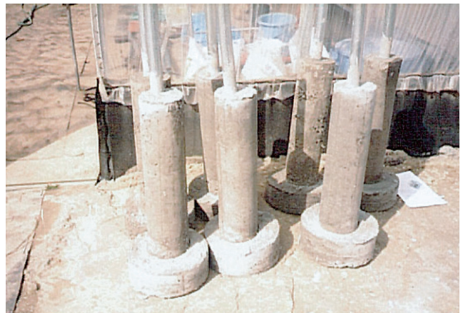
写真6 完成したベース付基礎
