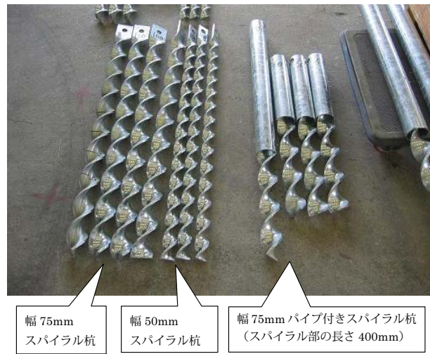
写真1 供試したスパイラル杭
