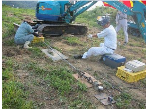
(b) 水平耐力試験風景 (傾斜圃場、傾斜上方向に牽引)
