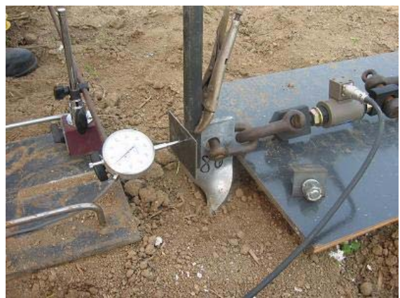
(d) 測定装置の取り付け状況 (水平方向)
