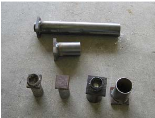
写真8 打ち込み用金具
