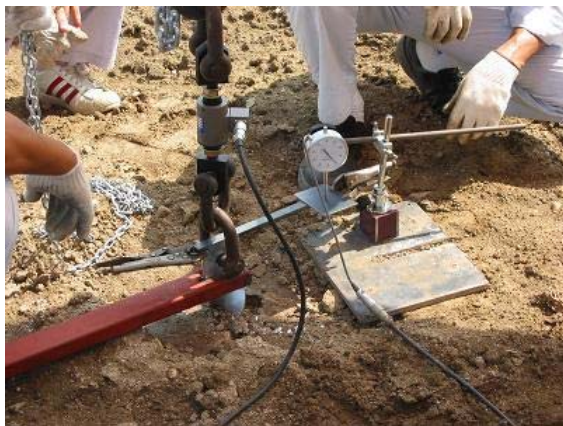
(c) 測定装置の取り付け状況 (垂直方向)
