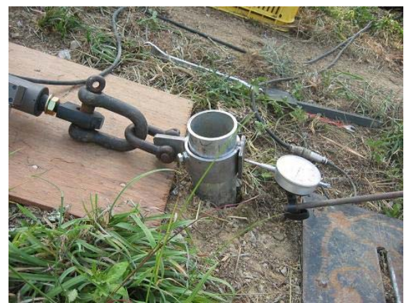
(f) 測定装置の取り付け状況 (傾斜圃場, 傾斜上方向に牽引)
