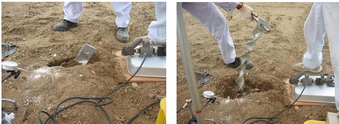
写真12 幅75mmスパイラル杭に約5 kNの水平荷重を作用させたときの杭の変形状況（施工深さ100cm）
