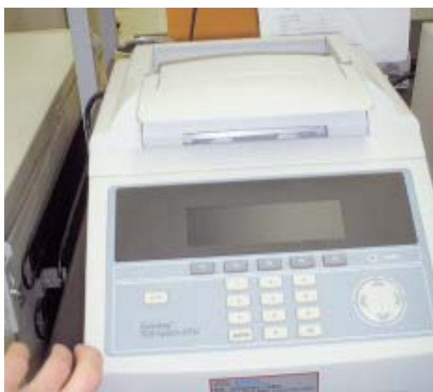
図2 マルチプレックスPCR法に利用するサーマルサイクラー
