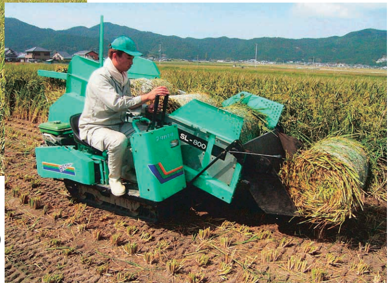
バケットでロールを積み込み搬出する運搬車
