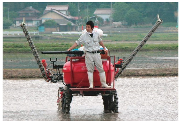
写真1 乗用管理機に乗って動力散布機で鉄コーティング種子を播種
