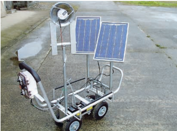
写真1 ファンを備えた施設内移動作業台車 （バッテリー搭載なので曇天でも大丈夫！）
