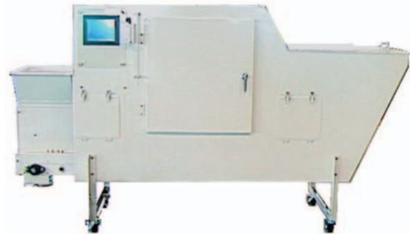
寸法 (W×H×D) 2450×1420×580mm, 質量 150kg 電源 AC200V0.4kW 及び AC100V0.2kW
