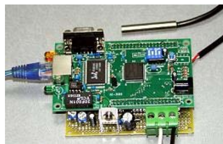
図1 ネット化マイコン基板 USE (サイズ 90mm×110mm)
