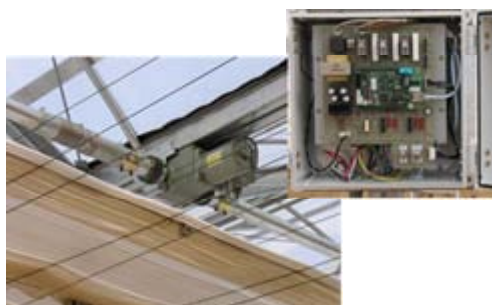
図2 ネット化マイコン搭載で自律動作可能なカーテン開閉ノード
