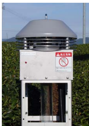
電撃型自動計数フェロモントラップと誘殺虫の計数精度
