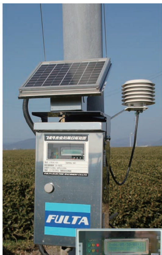
有効積算温度表示器の茶園設置例 右下：赤LED点灯時の表示部
