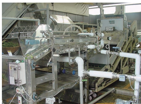
図1 低カフェイン処理装置の概略図(上)と実機写真(下)(株式会社寺田製作所で作製)
