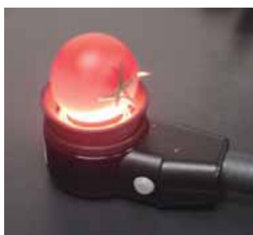
図1 光の拡散反射を利用したトマト品質の非破壊計測
