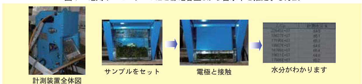
図 2 開発した方法を用いた含水率計測装置
