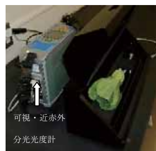
図3 チンゲンサイ葉柄に含 まれる硝酸イオン濃度 の非破壊計測の様子
