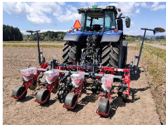
図 3-2-8 高速畝立て播種機
