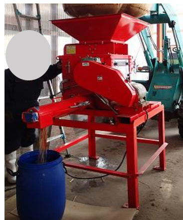
図 4-3-10 ロールミル （飼料用米破碎機 DHC-4010M、（株）デリカ）
