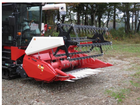
図 3-6-8 子実トウモロコシ収穫用のリールヘッダ
