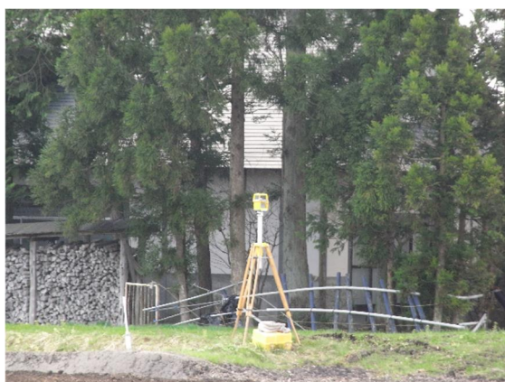
図 3-2-5 レーザーレベラと作業風景（左：発光機 右：受光機付き作業機）
