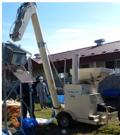
図 4-3-9 ハンマーミル （ミリングマシン U500I、（株）タカキタ）
