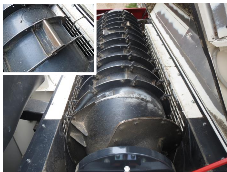
図 3-6-14 スクリュータイプのこぎ胴 左上写真はスクリューロータに装着されている拡散板
