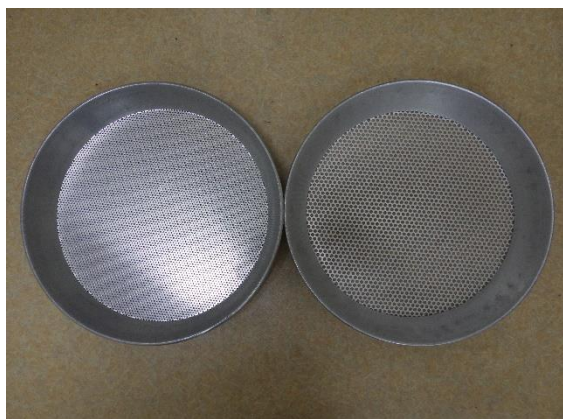
図 5-2-5 BCFM の調査で使用する篩 (左側が 6/64 インチ、右側が 12/64 インチ)
