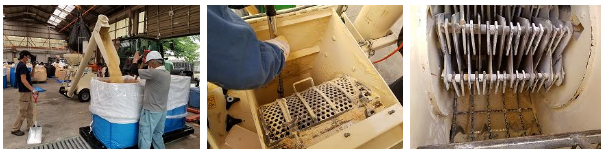
図 4-4-1 ハンマーミルによるトウモロコシ子実の粉碎
