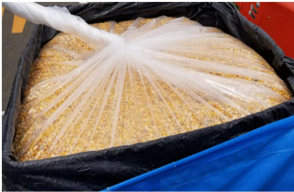
図 4-3-3 詰め込み後の内袋密封作業 空気は出来るだけ排除しつつ、素早く密封する。内袋に傷をつけないよう慎重に作業する。
