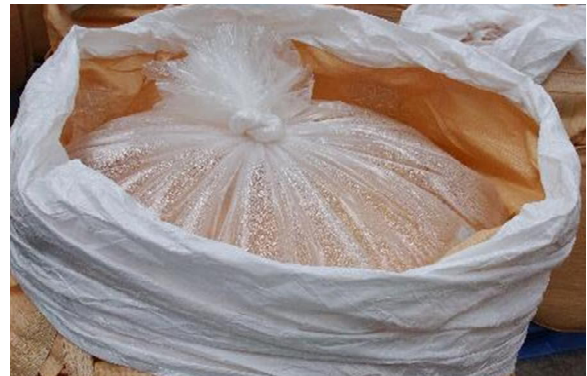
図 4-3-4 発生したガスにより膨張した内袋 発生したガスにより内袋の損傷が懸念される場合は、内袋の結束部をほどいてガス抜きを行う。
