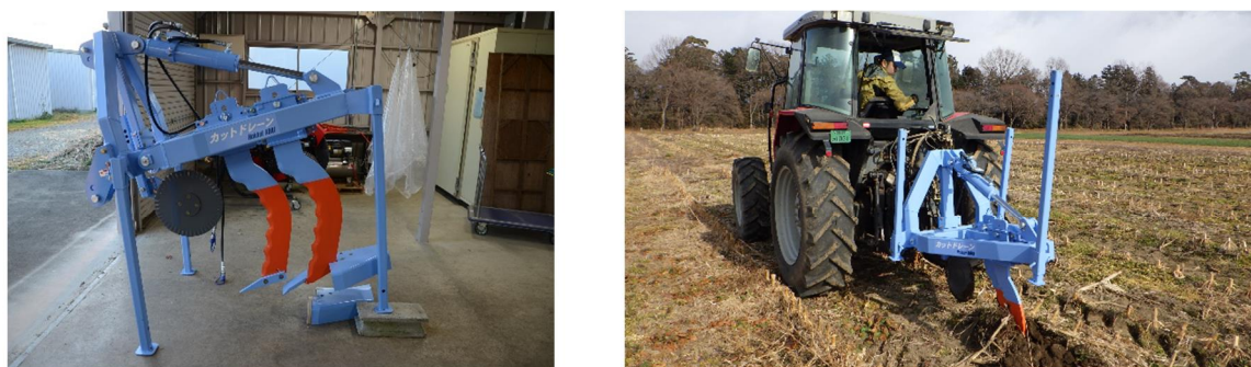
図 3-2-6 カットドレーンの構造（左）と作業風景（右）
