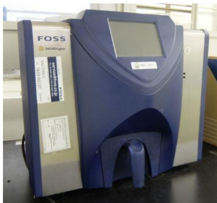
図 5-2-1 容積重を測定する計測装置 写真は、Dicky John 社製の GAC2500。
