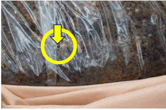
図 4-3-7 ネズミによる内袋の破損
