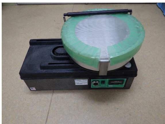
図 5-2-7 加振器を使用するには子実が飛散しないようにカバーを装着する
