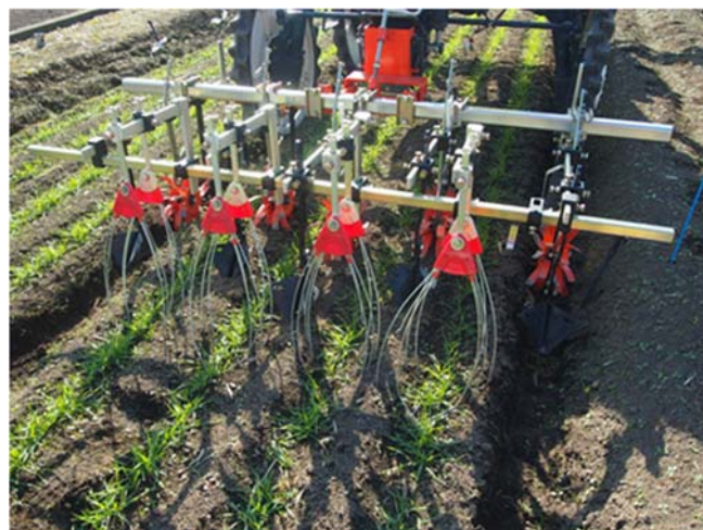
図1-6 使用したレーキ式除草機
