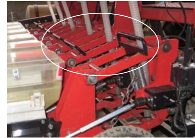
播種ユニット ・ 接地荷重可変式
