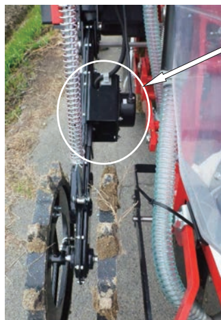
駆動輪にエンコーダを組み込み
