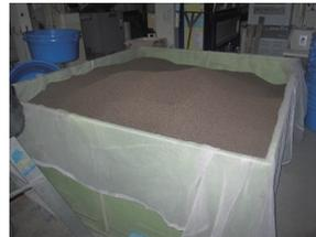
平型乾燥機(寒冷沙で漏下防止)
