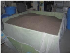
平型乾燥機(寒冷沙で漏下防止)
