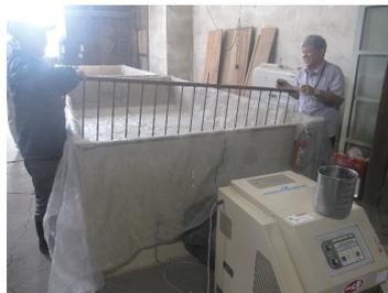
平型乾燥機(寒冷沙で漏下防止)
