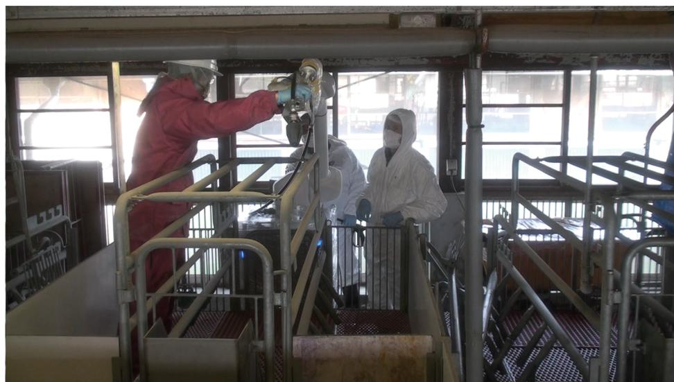
ダイレクトティーチングと、動作の再生による洗浄作業
