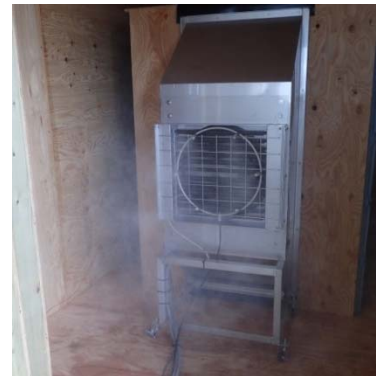
写真1 断熱庫内でミスト散水とヒーターにより定植苗を50℃まで加熱
