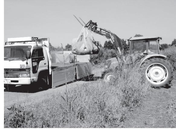
図4 フレコンの運搬とトラックへの積載
