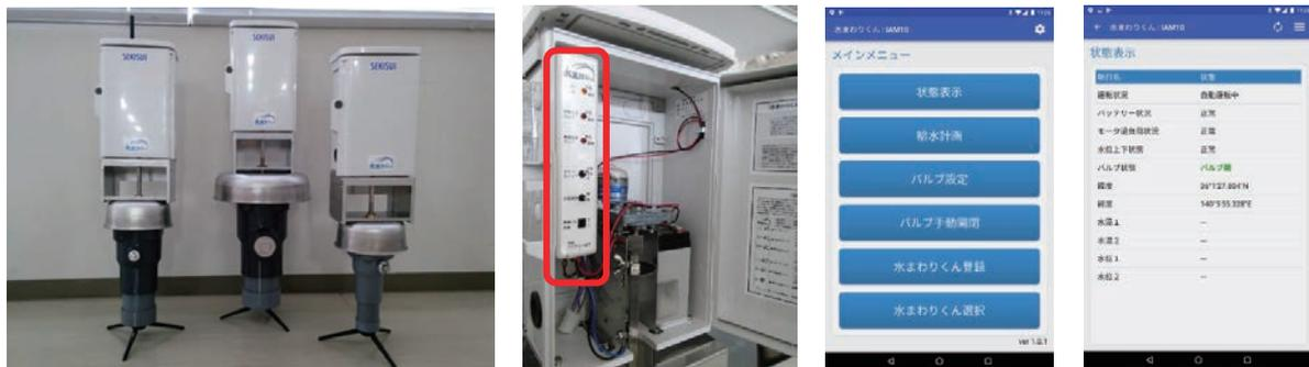
(a)左から管径Φ75、100、50 (b)赤枠内が制御ボックス (c)給水栓と接続し状態表示中
