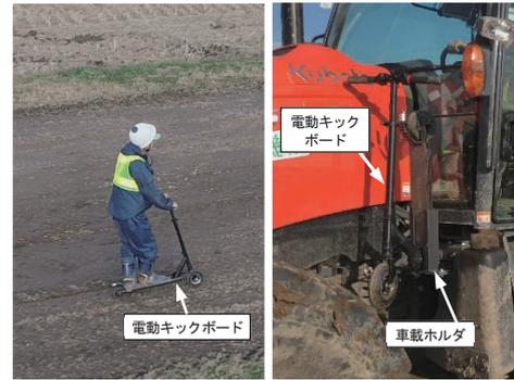
図4 電動キックボードによる移動（左）とロボットトラへの積載状態（右）
