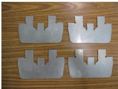
図2:ワイヤ放電加工機使用例
