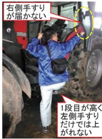
図1 事故現地詳細調査・分析結果の一例(2019 安全装備検査基準で乗降時の3点支持を明記)
