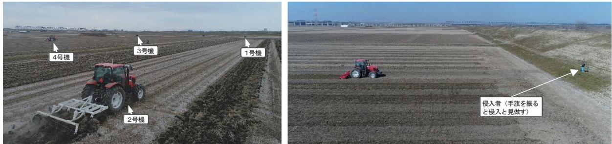
図2 作業試験のようす（左）と車載カメラによる侵入試験の実施状況（右）
