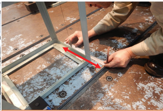
トラクタの据付時の車体中心について水平面投影を行うに適切な技能を有しているか？
