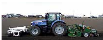
水稲乾田直播栽培における耕起、碎土、播種を一度に行う複合作業
