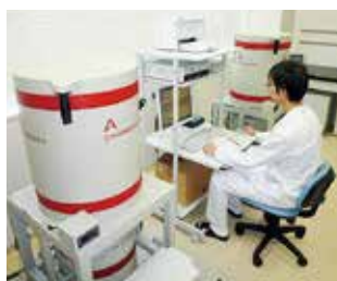
ゲルマニウム半導体検出器による放射性物質分析
