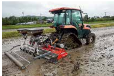
代かき同時浅層土中播種機による水稲の無コーティング種子の播種
