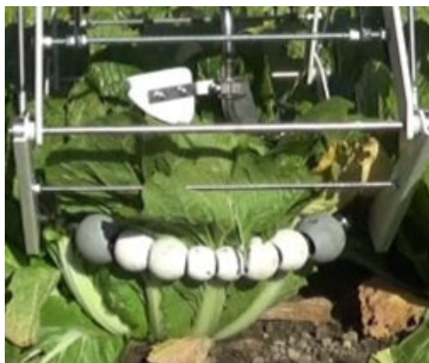
ガイドローラーにより外葉を持ち上げ
