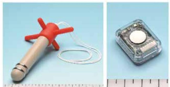
動衛研が開発した腔内センサ(左)と尾部センサ(右)。
