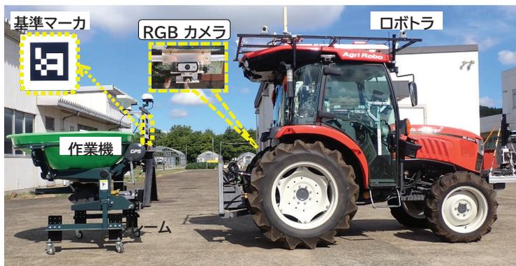
基準マーカとRGBカメラによる作業機の位置計測のためのマシンビジョンの構成
