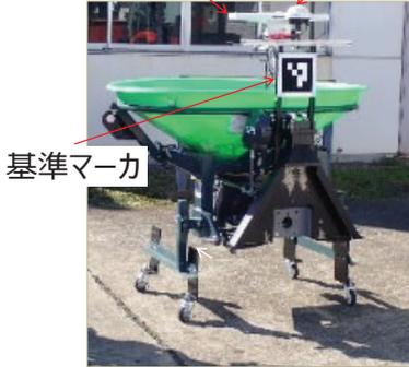
**試験条件** 光照度 約6千～8万lux、太陽高度約35°、カメラの解像度 640x480ピクセル、フレームレート30FPS
