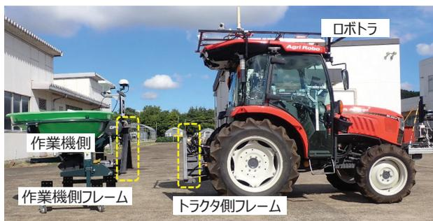
作業機側フレームとトラクタ側フレームの装着状態
