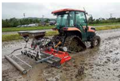
代かき同時浅層土中播種機による水稻の無コーティング種子の播種
