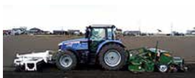
水稻乾田直播栽培における耕起、碎土、播種を一度に行う複合作業
