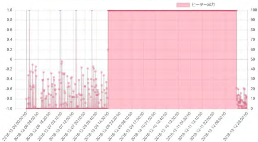
図 7-1 ヒーター出力の経日変化
