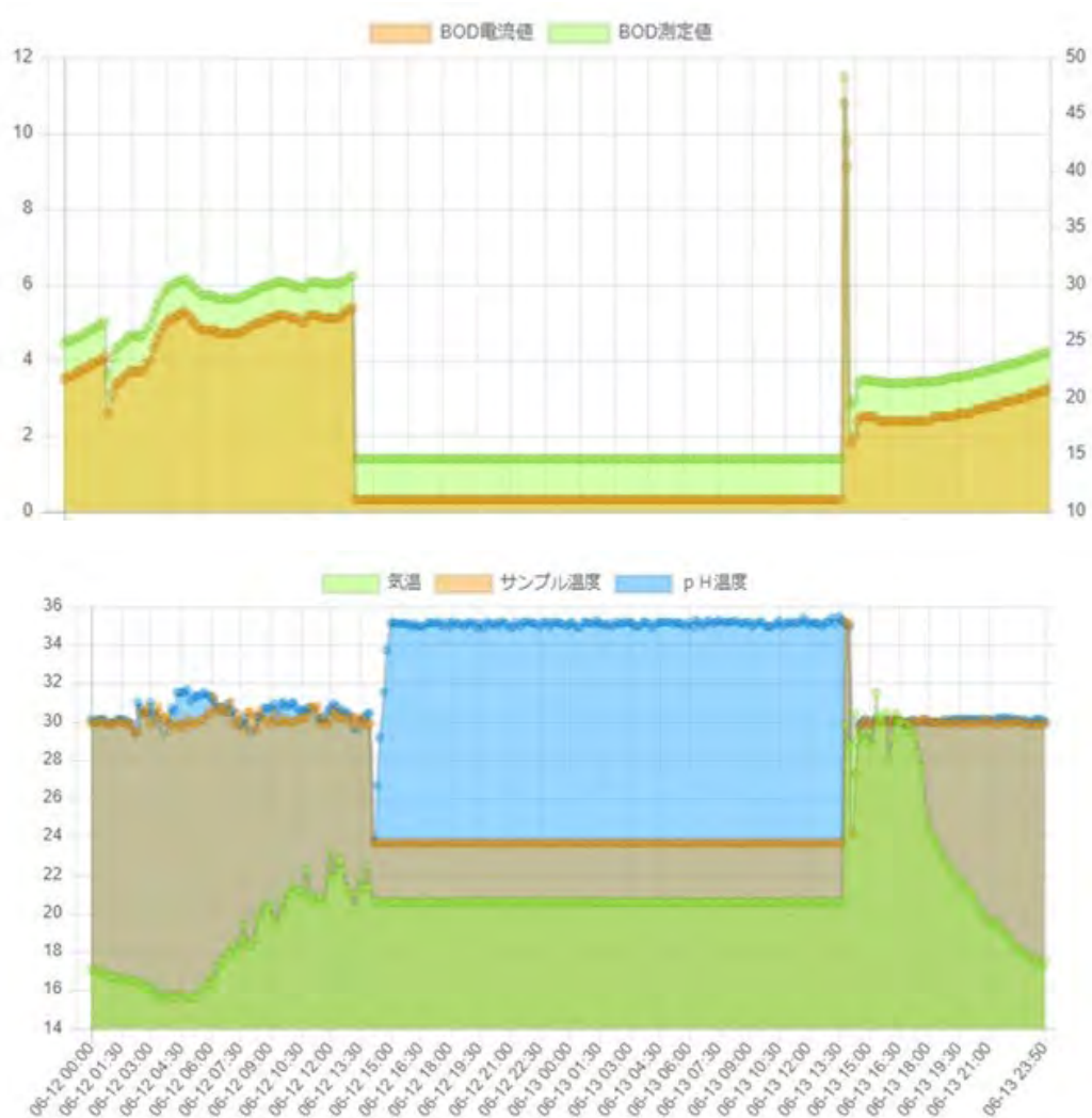
図 7-8 電流値、BOD測定値、気温、培養器内水温、pHの経日変化
