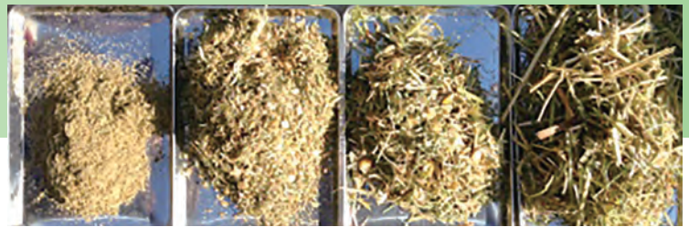
<1.18mm >1.18mm >8mm >19mm 篩い分けした微細断WCS
