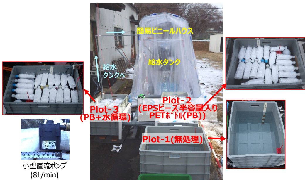
図11 新技術による水槽凍結抑制実験の様子
